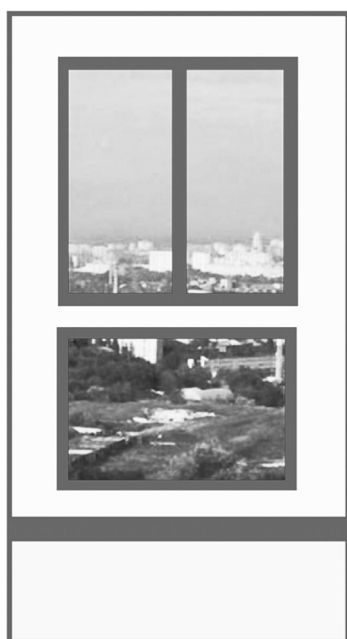
Des bow-windows et des allèges vitrées permettent de meilleures vues sur l'extérieur
